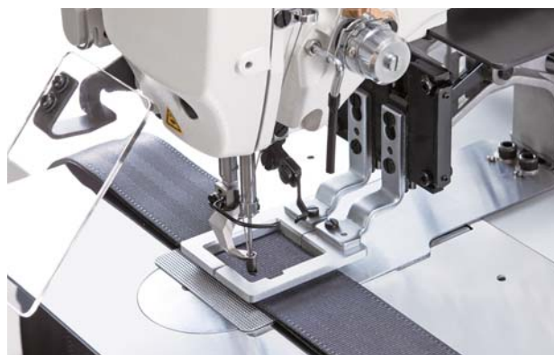
用途实例：汽车安全带补强缝 * 外压脚为特制品。
