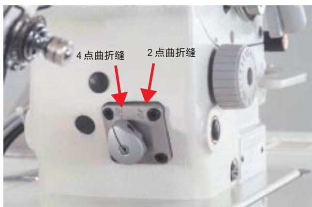
2 点曲折缝·4 点曲折缝的切换扳手
