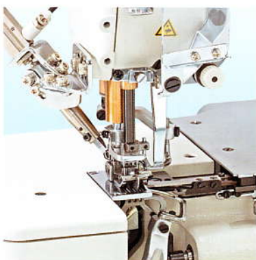
气动式上下剪线结构
