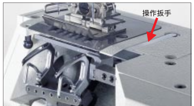
穿线时的弯针位置(弯针倒向位置)
