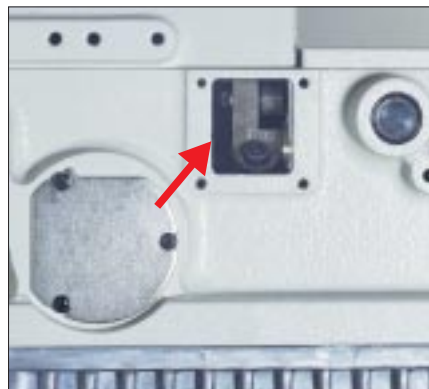
针送布量的差动调整机构
