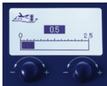
压脚的抬升高度可按0.1毫米的增量进行调节, 可根据不同材料进行精细调整。
