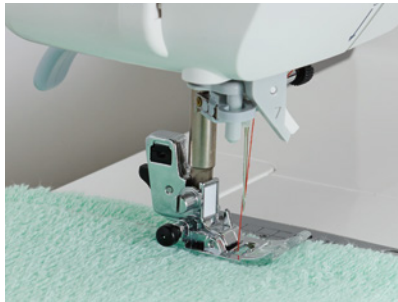
缝制毛巾布 均匀输送难以缝制的高绒面料。
