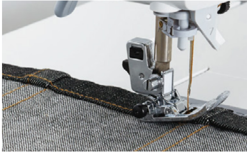
三层折叠厚牛仔布进行平缝接缝 轻松均匀地缝制厚重面料。
