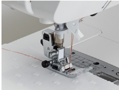
缝制薄面料 即使缝制轻质棉布, 面料也不会收缩。
