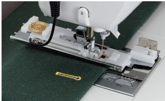
锁眼缝纫压脚配备夹板, 您可以通过将面料夹持在夹板与压脚之间, 从而安心地进行送布。
