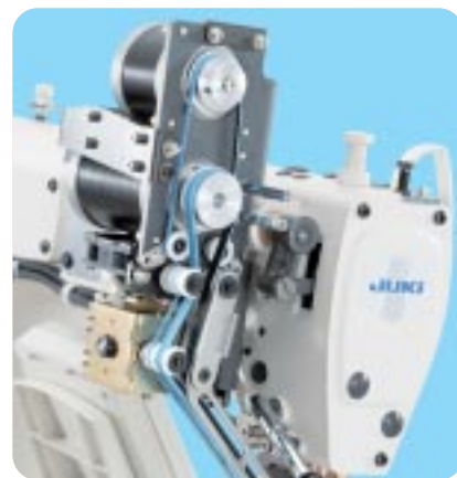
新型皮带送布机构
