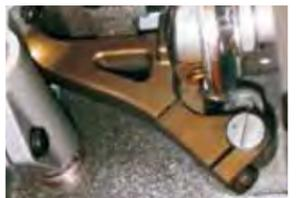
送布牙的高度、倾斜角度调整范围可以从后倾开始到前倾范围进行调整。在重视针迹形成的刺入时的轨迹的同时使送布轨迹最合理化。送布机构多采用铝实现了轻量化，提升了面料的贴合性，更容易跨越结合部，送布力也相应提升。
