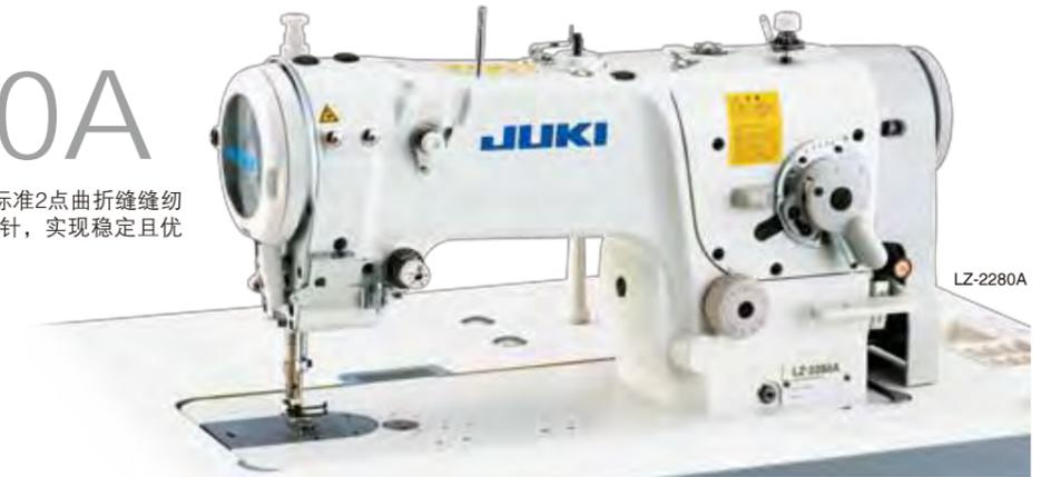
对应不同应用，可以选择针摆幅 5mm（A 型）与针摆幅 8mm（B 型）的缝纫机。
