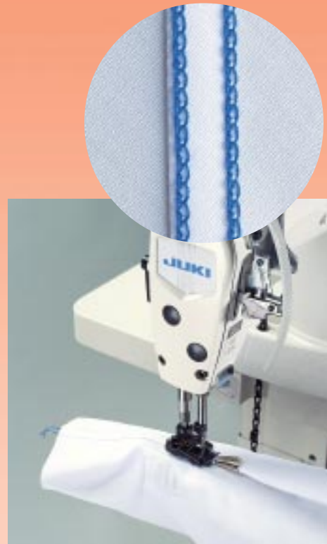
● 由于实现了低张力缝制而形成手感柔合的线迹。
