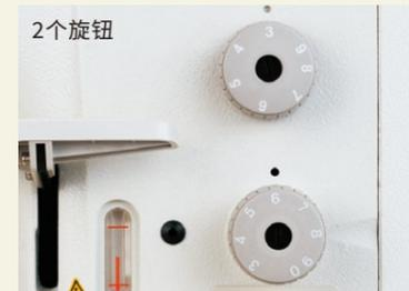
自动切线机型标准配置了2种针距旋钮。1台缝纫机可以瞬间切换2种不同的针距。
