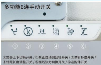
配置了触摸式开关与多功能的6连开关。交替上下量切换,针距长度切换等只需要按一下按钮就可以完成操作。
