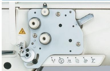
自动切线规格配置了6连手动开关,可以调整面线张力的强弱(提升对厚料的对应力)
