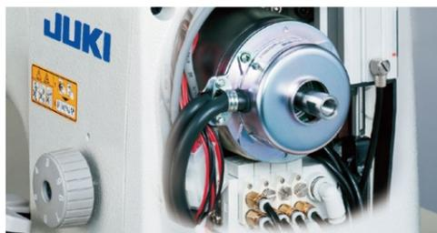
自动切线规格采用了对应厚料的高扭矩直驱马达。优秀的应答性能在缝制结合部的时候也能确保强劲的穿透力。
