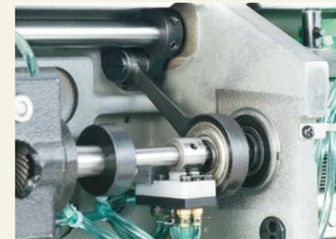
可以调节下送布的上下运动量。能实现面料与线在最合适的配合状态下的缝制。不需要用其他缝纫机进行辅助缝制。
