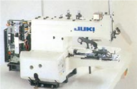
●電路板馬達及操作盤形成機頭一體的小巧設計
