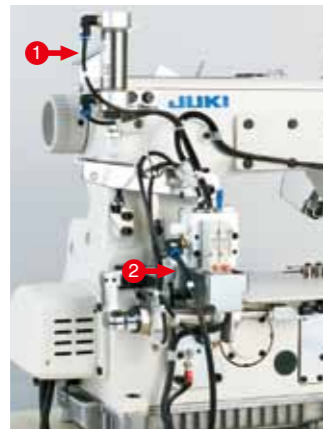
① 气动式抬压脚 ② 气动式切线
