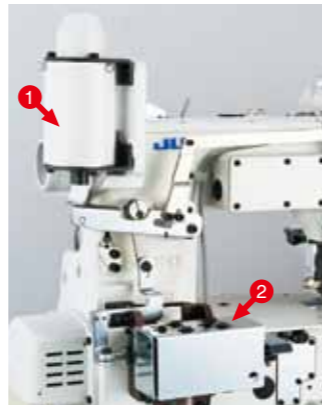
① 电磁式压脚抬升驱动 ② 电磁式切线
