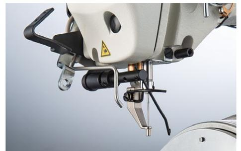
面线夹线装置,面线手动机构
