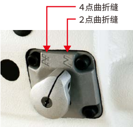
2点曲折缝・4点曲折缝的 切换扳手
