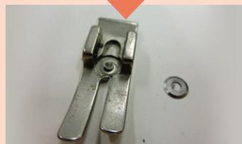
该圆盘会因为缝制时的振动, 进行360°的转动, 从而维持了最适合的切线时机。
