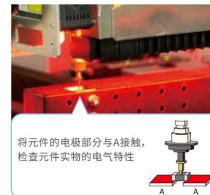
将元件的电极部分与A接触，检查元件实物的电气特性
