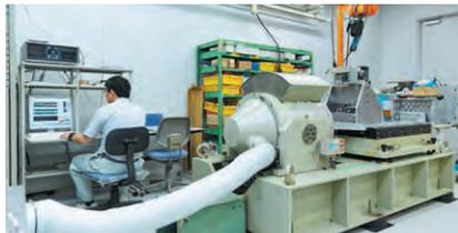
使用振动机实施振动试验
