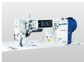
微油式高速综合送布水平大旋梭切线缝制系统
