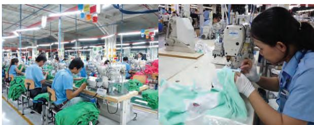
“在规定时间内生产规定数量的优质产品”是我们全体员工的口号。在TMI公司的现场，他们开动脑筋提出了各种独特的方案，譬如设置辅助机台确保稳定传送面料，避免空调的吹风，在所有的缝纫机上安装缝纫机线箱确保稳定地拉出机线等。
