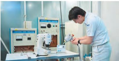
使用静电试验设备的测试
