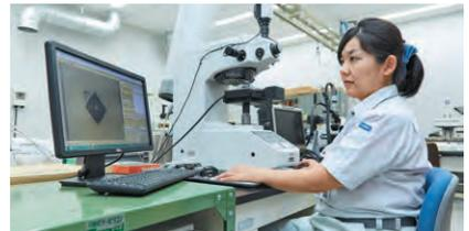
使用维氏硬度计的硬度试验
