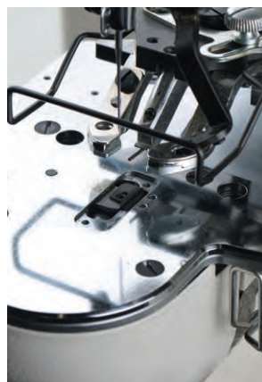
LK-1903BB的短残线结构
