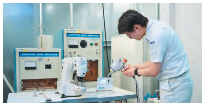
使用静电试验设备的测试
