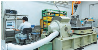
使用振动机实施振动试验
