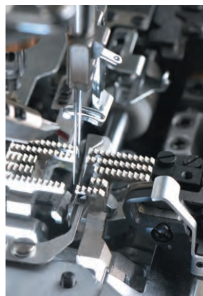
MF-7900打线结的机构
