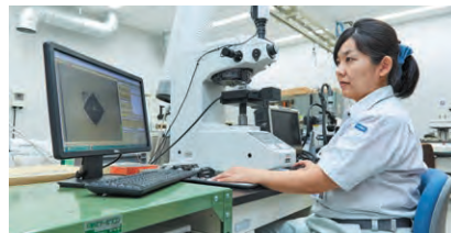
使用维氏硬度计的硬度试验
