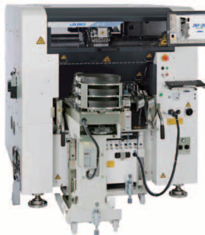
实现人工插入工序自动化的JM-20
