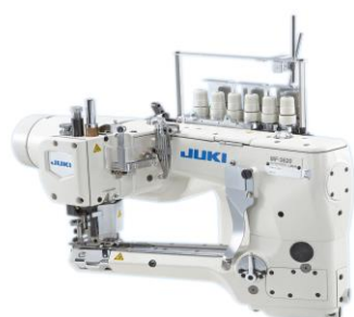
四针六线曲臂型筒式上下差动送布 缝纫机
