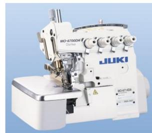
高速无供油机头包缝机/
