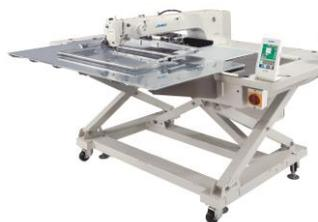
带输入功能的电子花样循环缝缝机
